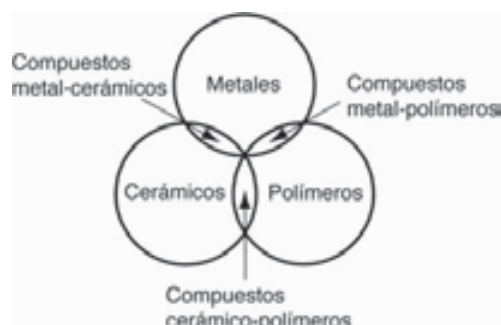
FIGURA 1.3 Diagrama de Venn que muestra los tres tipos de materiales básicos más los compuestos.
