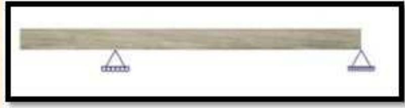
**Vigas continuas:** una viga estáticamente indeterminada que se extiende sobre tres o más apoyos.
