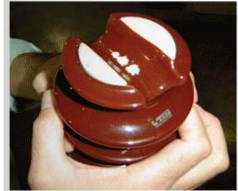
Aislante dañado por el "tracking" y un eventual arco
